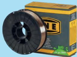
Die Massivdrahtelektrode INEFIL 19.12, G4Si1 (SG3) wird für das ein- und mehrlagige Schweißen un- und niedriglegierter Stähle unter Schutzgas in allen Positionen verwendet. Der Schweißvorgang erfolgt unter Nutzung der Schutzgasarten Ar/CO<sub>2</sub>, Ar/O<sub>2</sub> und CO<sub>2</sub> Gemisch. Behälterbau, chemische Industrie, Industriemaschinenbau, Stahlbau, Fahrzeugbau sowie Rahmen- und Anlagenbau sind wichtige Anwendungsgebiete dieses Drahtes.
