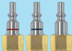
Der Kupplungsstift SK 100-1 nach Norm EN 561/ ISO 7289 ermöglicht als Teil des Kupplungssystems SK 100 das blitzschnelle An- und Abkuppeln des Schlauches beim Wechsel des Arbeitsgerätes oder des Arbeitsortes. Er wird zum Anschluss an das Arbeitsgerät eingesetzt. Er ist aus widerstandsfähigem Edelstahl (HRC 25) gefertigt. Die unterschiedlichen Stiftformen für Brenngase, Sauerstoff und andere Gase verhindern eine Verwechslung der Anschlüsse.
